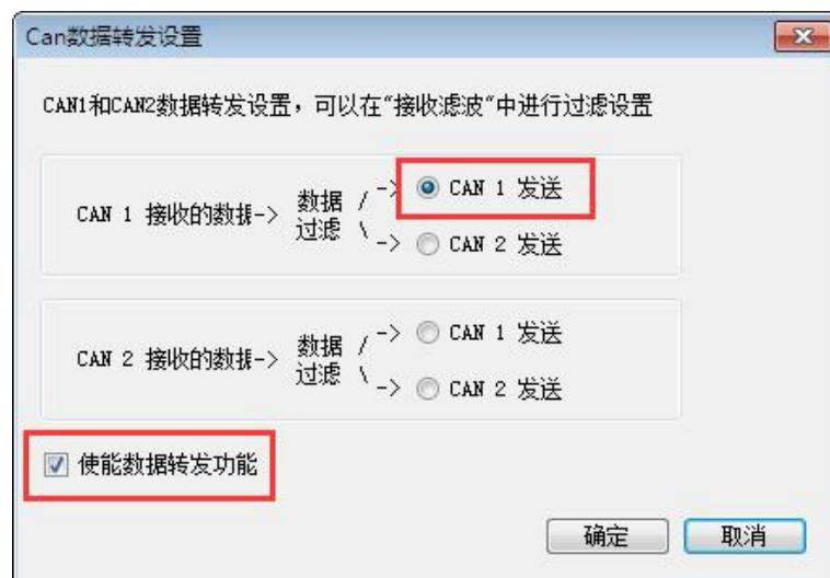
②CAN1 接收的数据-CAN2 发送: CAN1 通道收到数据后经过滤波将这条数据从 CAN2 通道发出, 此处 CAN1 和 CAN2 通道可设置不同的波特率。
