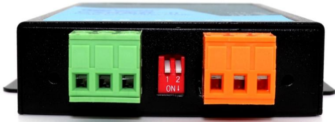
图 2.5 GCAN-208-2-FA CAN 总线接口及电源接口位置
