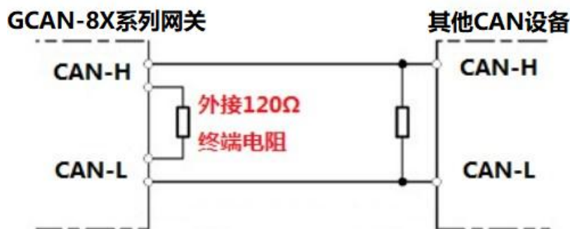
图 4.4 GCAN-GT-8221 与其他 CAN 节点设备连接
