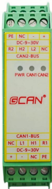
图 2.3 GCAN-226-N 模块接线端子排
