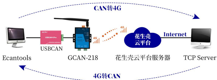
图 3.17 GCAN-218 工作环境通讯示意图
