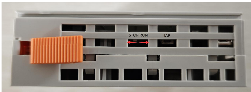
4.1 设备顶端开关和复位键实物图
