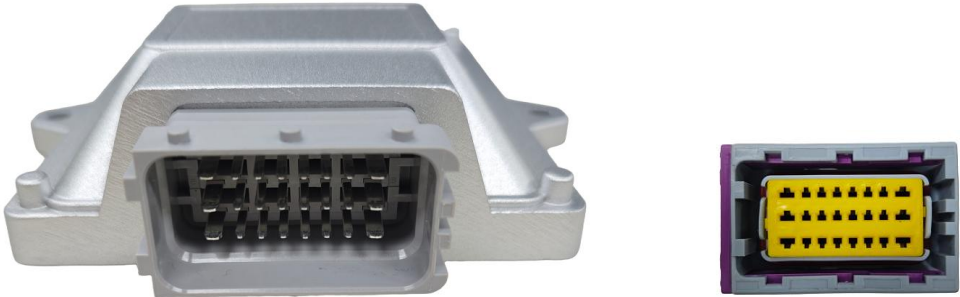
图 2.3 GCAN-212-W 模块接线端子排
