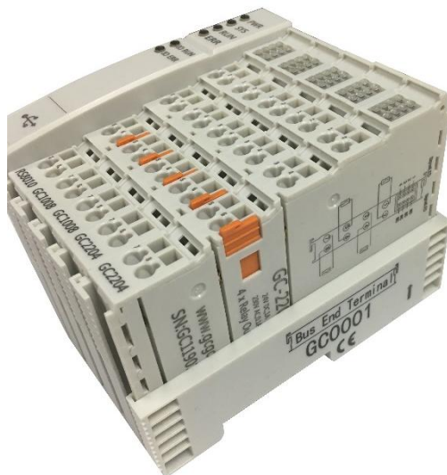
图 2.5 GC-0001 终端电阻模块安装方法
