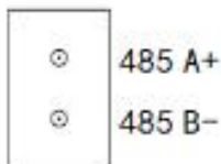
图 2.8 GCAN-PLC-301/302 的 RS485 总线端子排
