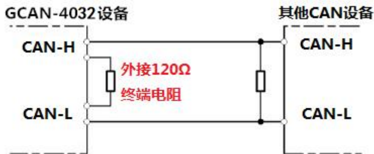
图 3.2 GCAN-4032 与其他 CAN 节点设备连接
