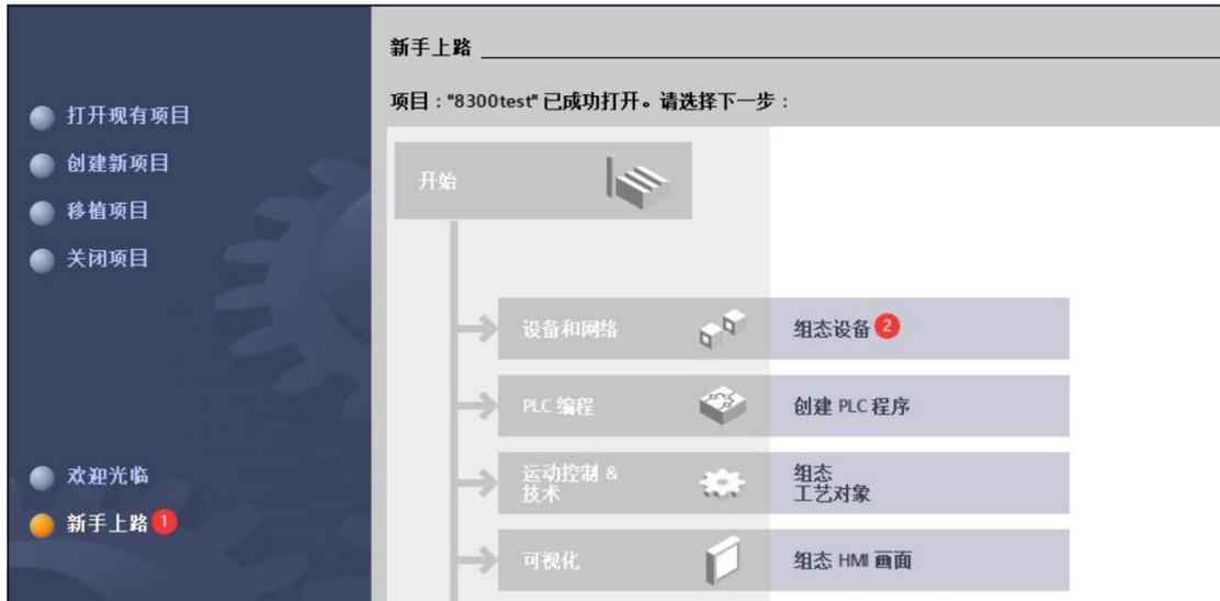
(3) 在“设备与网络”中，点击“添加新设备”，选择“控制器”，选择当前所使用的 PLC 型号，点击“添加”，完成添加控制器操作；
