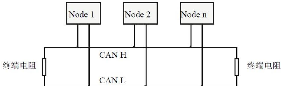
图 3.5 CAN-bus 网络的拓扑结构
