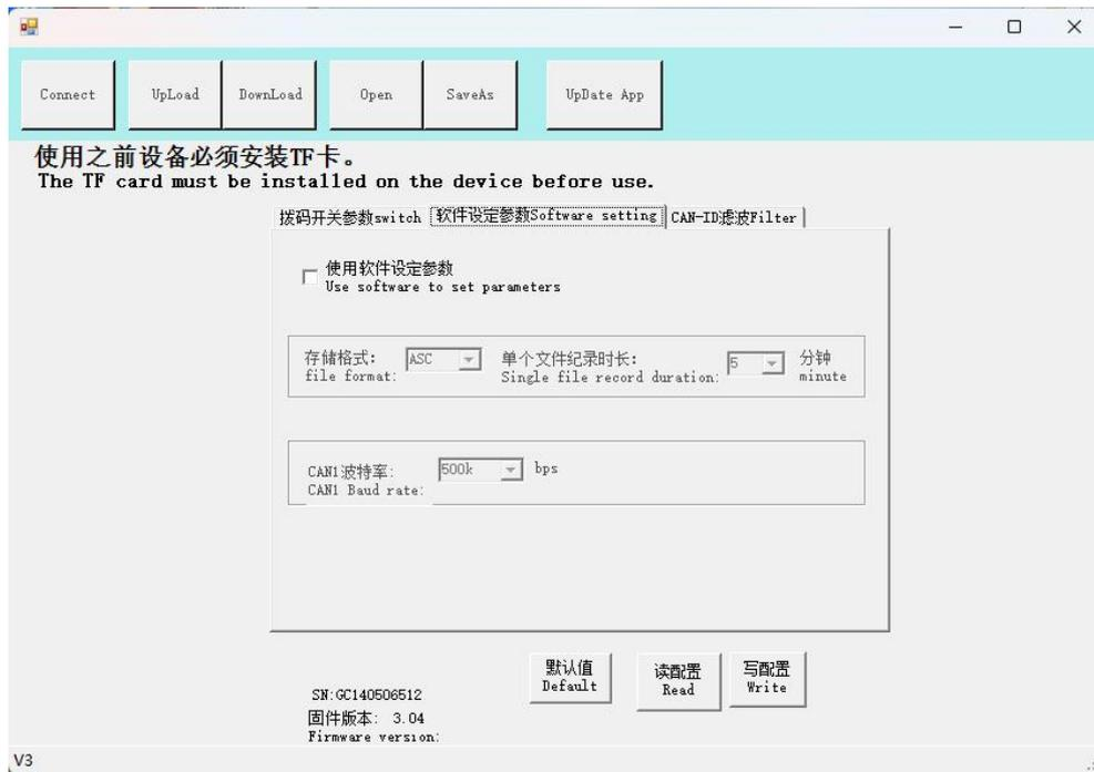
图3.4 软件配置参数设置
