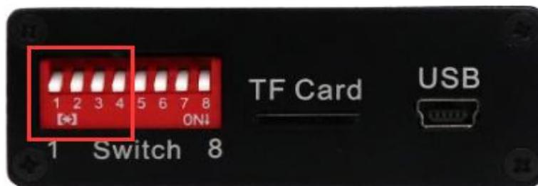
图 3.6 CAN 总线数据存储器模块侧面图
