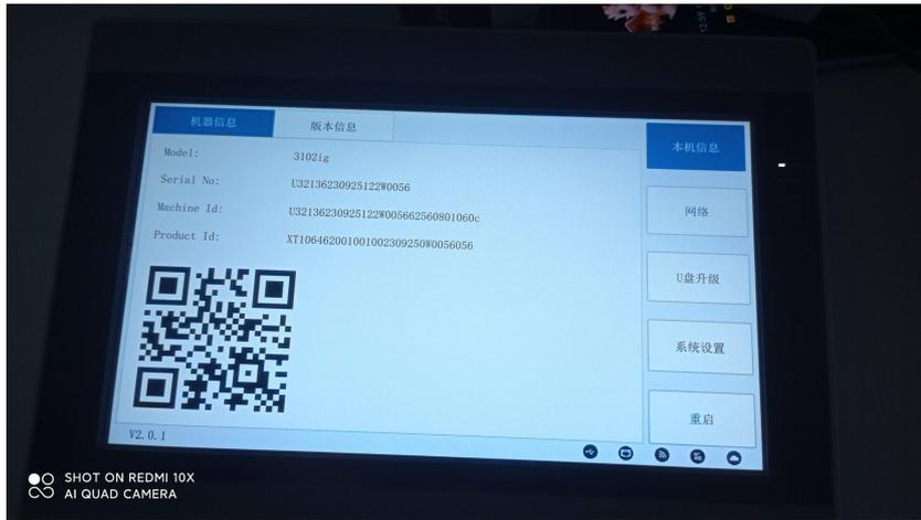
点击【网络】，然后点击【以太网】，并打开以太网，设置静态 IP 与 PLC 设置同一网段地址。目的是 PLC 和 HMI 可以进行通讯。
