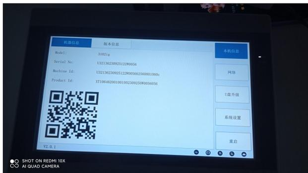
点击【网络】，然后点击【以太网】，并打开以太网，设置静态 IP 以及 PLC 设置与网络同一网段地址。三个地址必须在同一网段，否则有网连接不上 PLC 或者连接上 PLC 连接不上网络。（这里因为我的网络网段是 0 网段，所以 HMI 和 PLC 的网段都设置成 0 网段）
