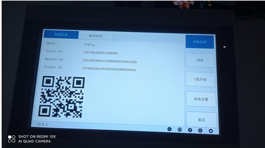
点击【网络】，然后点击【以太网】，并打开以太网，设置静态 IP 与 PLC 设置同一网段地址。目的是 PLC 和 HMI 可以进行通讯。
