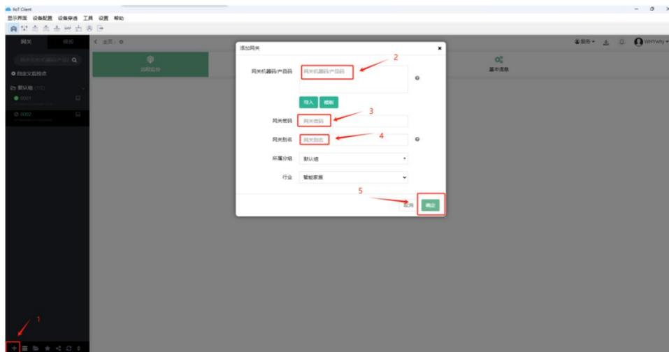
添加后设备树里出现有已添加设备，绿色代表此时设备在线，并可以鼠标点击屏幕进行远程操作。
