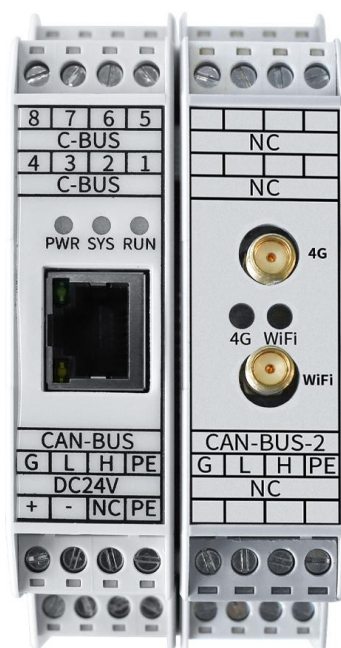
图 2.3 GCAN-GT-415 模块接线端子排
