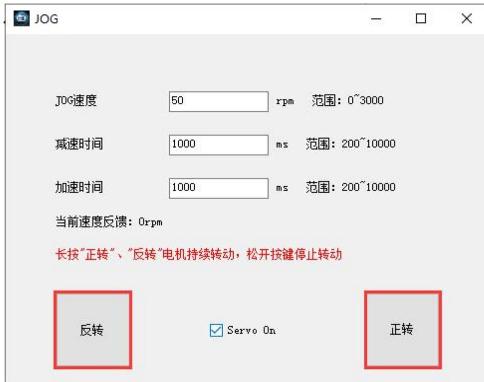
按住“正转”或“反转”，能够使电机持续转动，并在松开鼠标按键时停止转动。
