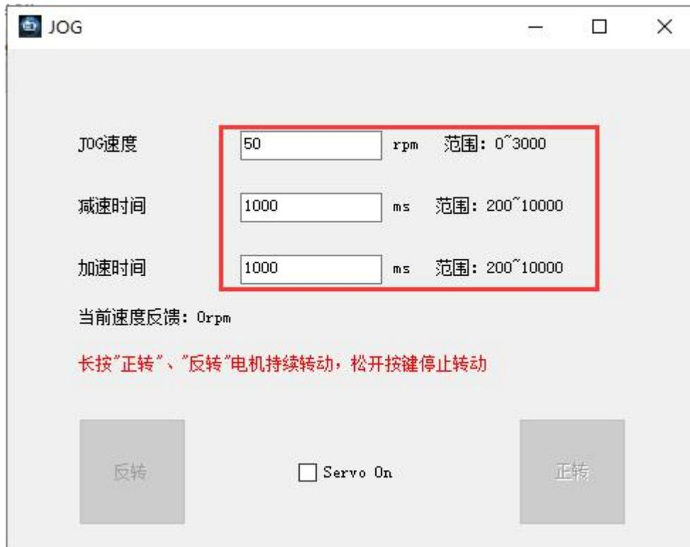
JOG 速度：设定电机运行的速度。
