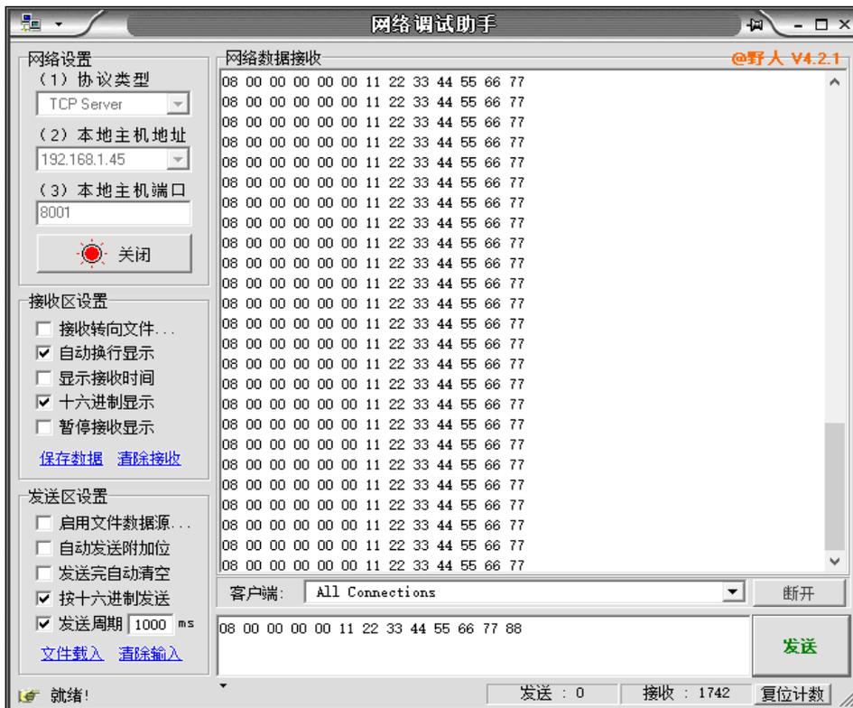
**请注意：配置成功后需重新对 GCAN-212 设备上电。在使用网络调试助手时您需要勾选“十六进制显示”、“十六进制发送”。**
