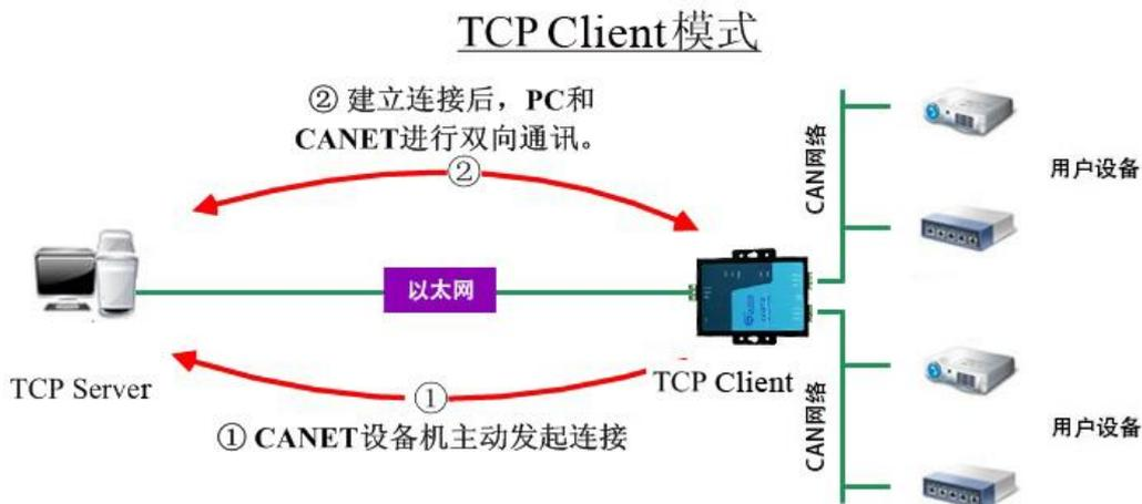
图 3.5 TCP Client 模式通讯示意图
