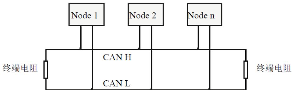
图 3.7 CAN-bus 网络的拓扑结构
