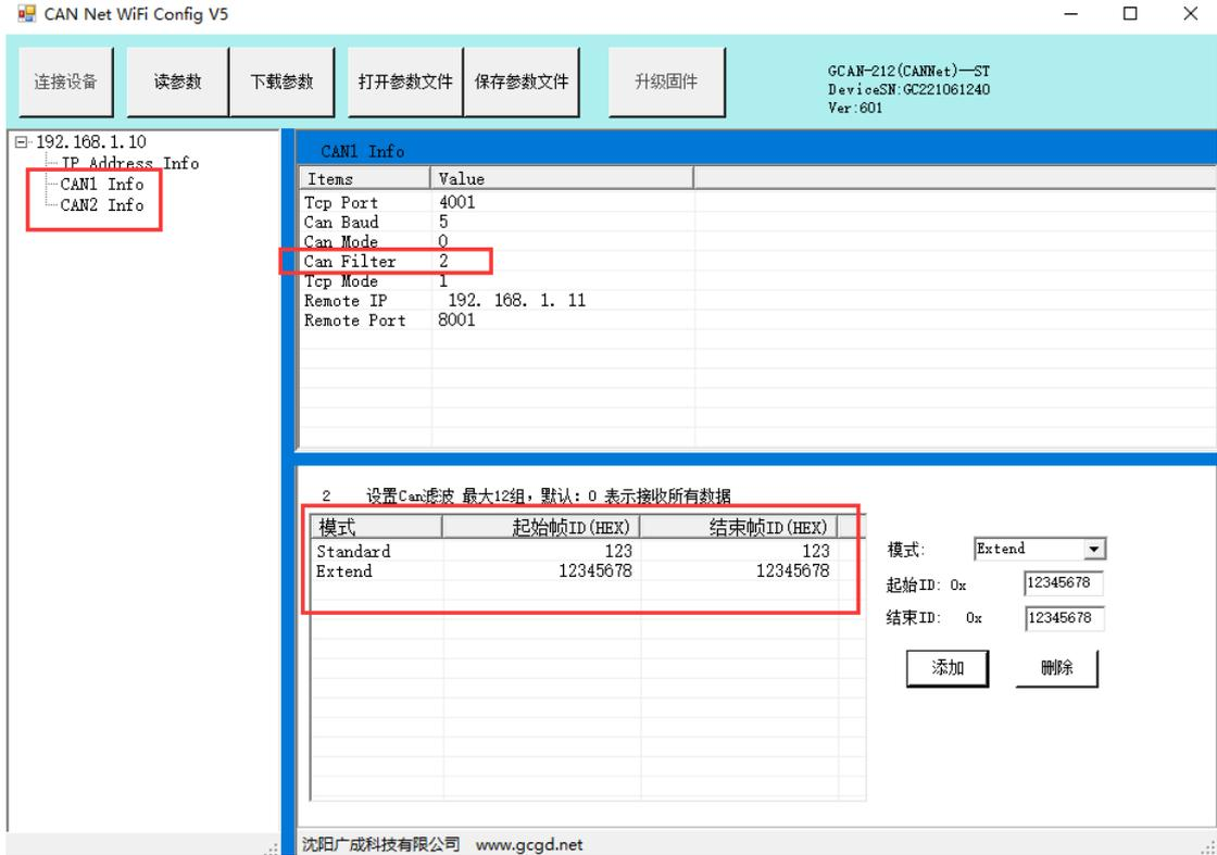
图 4.6 广成科技 GCAN-212 配置软件设置滤波
