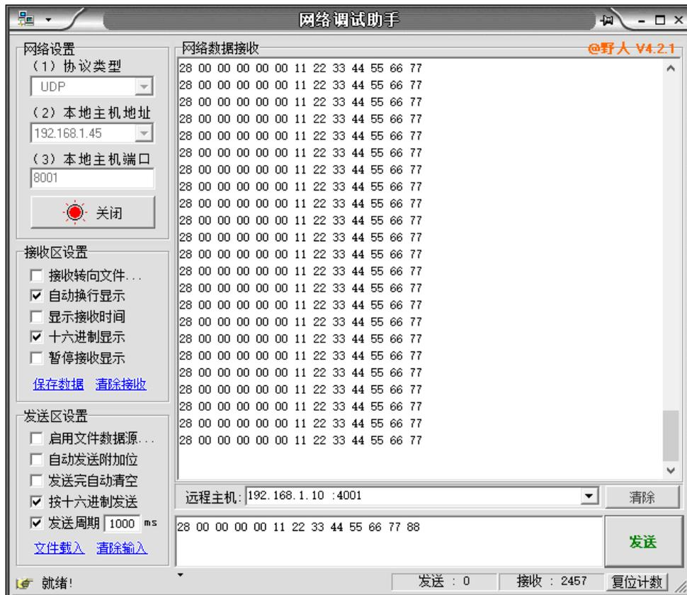
**请注意：配置成功后需重新对 GCAN-212 设备上电。在使用网络调试助手时您需要勾选“十六进制显示”、“十六进制发送”。**
