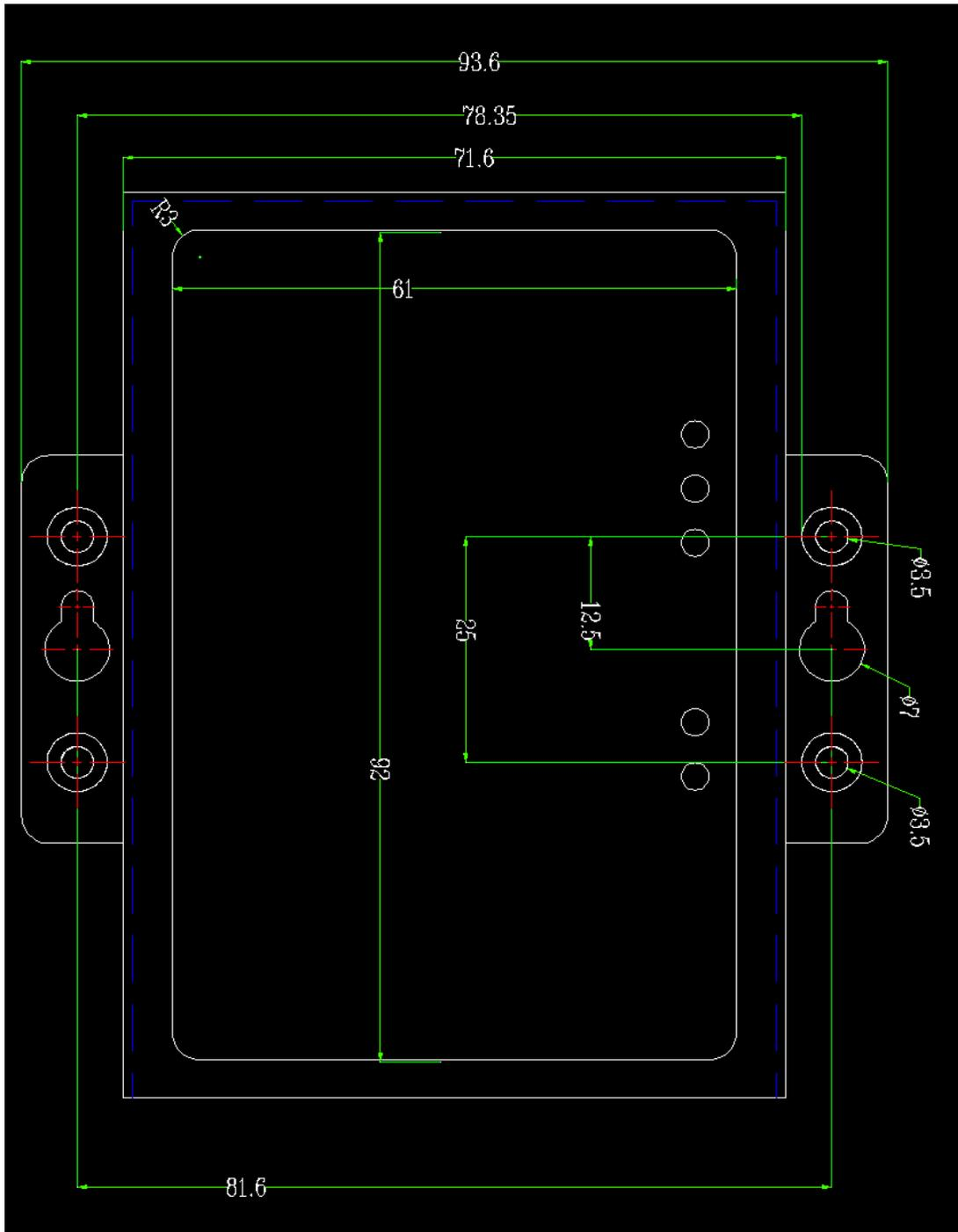
图 2.2 GCAN-212 安装尺寸
