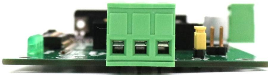
图 3.3 GCAN-305 模块评估板 CAN-bus 接口
