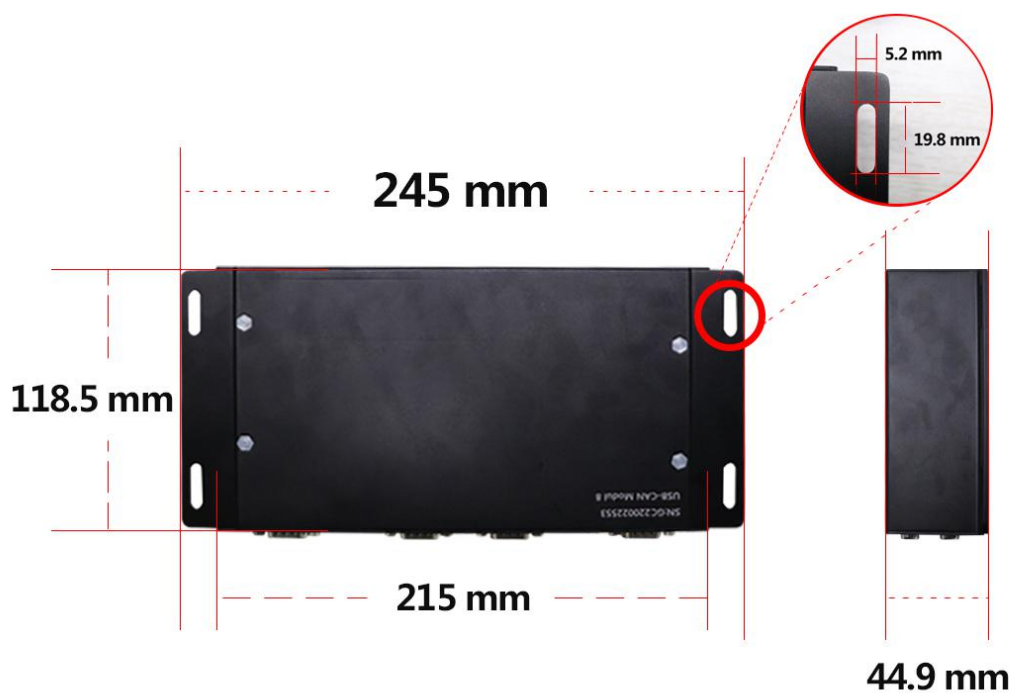
图 2.1 USBCAN-Modul 8 外形尺寸
