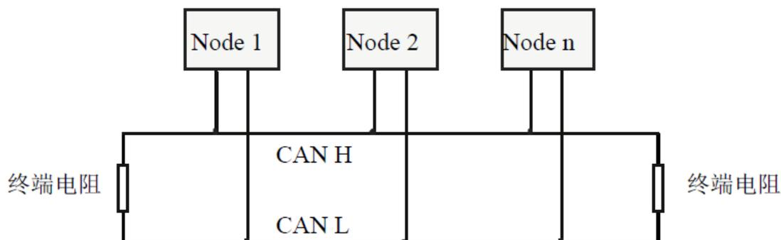
图 3.7 CAN 网络的拓扑结构
