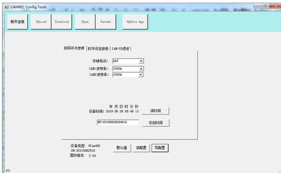
图3.3 拨码开关参数设置
