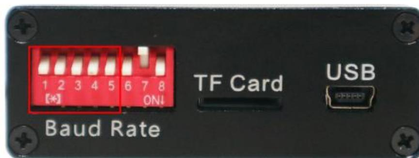
图 3.6 CAN 总线数据存储器模块侧面图
