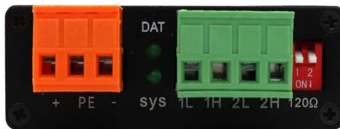
图 2.2 电源接口、CAN-bus 接口位置
