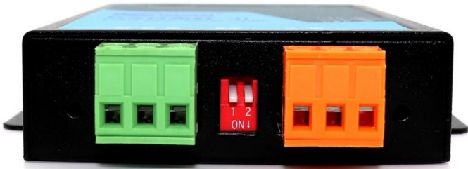
图 2.5 GCAN-208-2CAN 总线接口及电源接口位置
