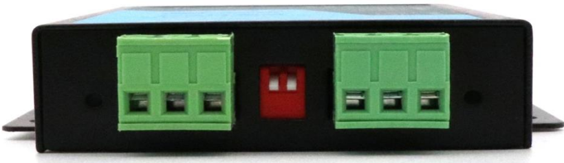
图 2.4 GCAN-208-1 模块 CAN 总线接口
