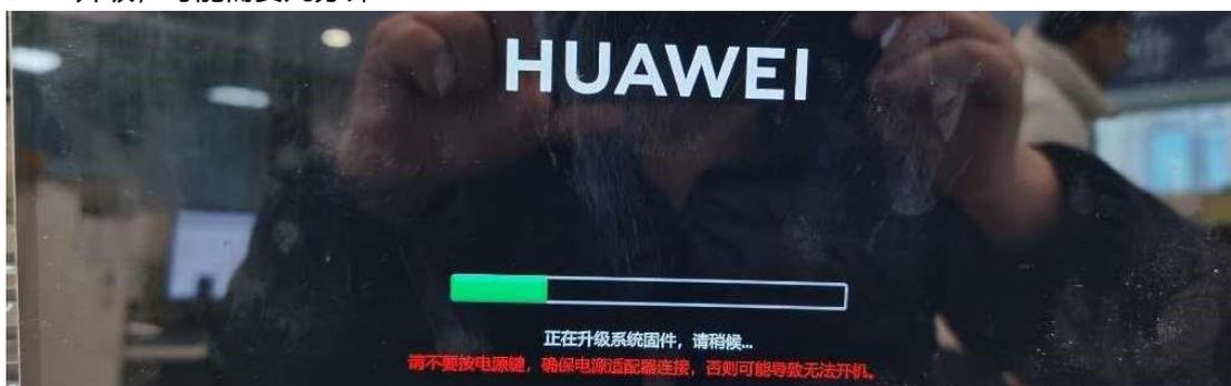
2. 待升级完成, 机器正常重启, 固件和BIOS即升级完成, 随后更新镜像即可
