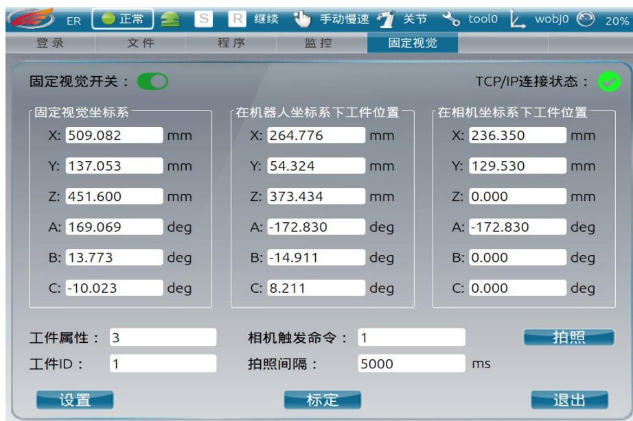
图 3-2 机器人手眼标定的主界面
