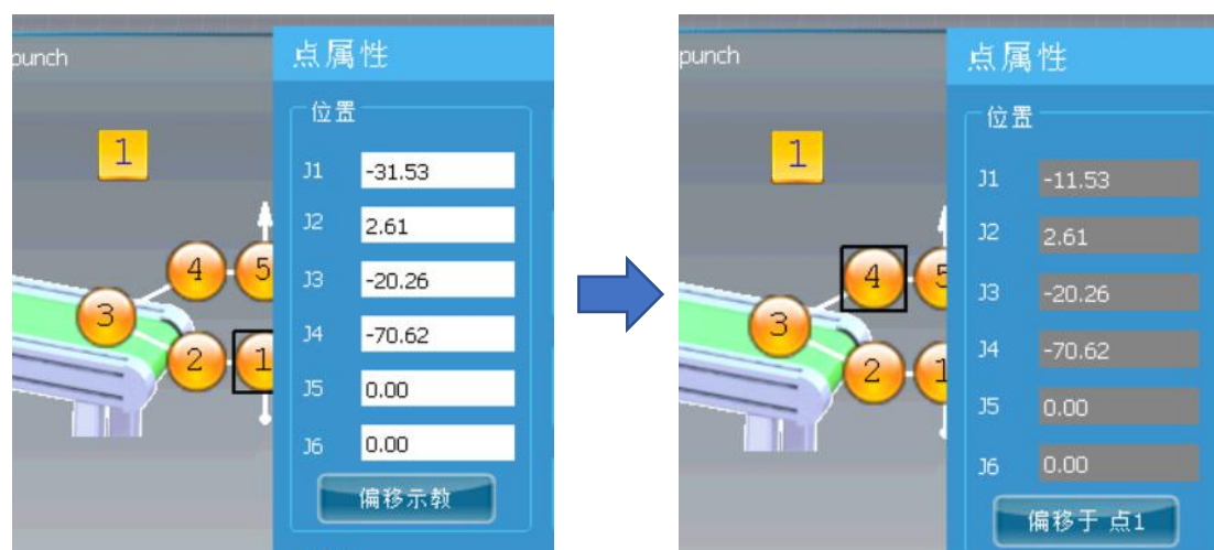
b 参考点“1”修改后基于参考点 1 的偏移点“4”的位置
